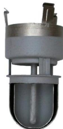
б) Погружная капсула SinterCast для ТА
